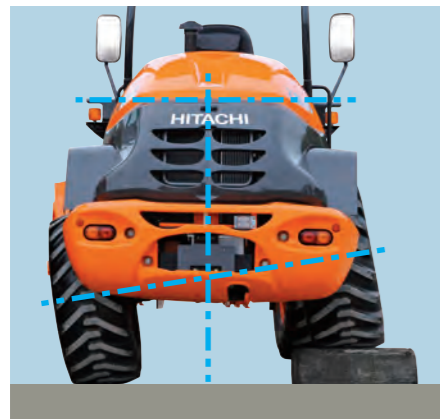
路面の凹凸に追従するリアアクスルオシレーション
