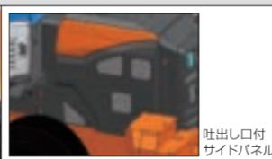
ラジエータに入り込む大きなゴミを事前にキャッチするラジエータダストスクリーンを装備。清掃の手間を省き、オーバーヒートのリスクを低減します。また、清掃しやすい車体後方側でゴミをキャッチするため、サクシジョン (吸い込み) ファン、吐出し口付サイドパネルとセットです。
