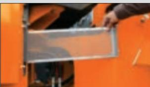
エアコンコンデンサへのゴミ侵入を低減するスクリーンを装備。分割式のスクリーンで容易に着脱・清掃が可能です。
