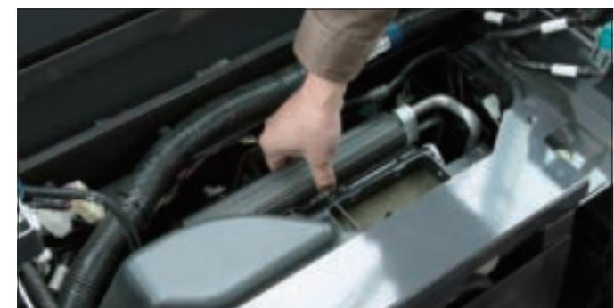
内外気フィルタの集じん効率を上げ、エアコンユニットに侵入する粉じんを大幅に低減しました。さらにエバボレータの材質を見直すことで、耐食性を2倍に向上<sup>\*</sup>。万一、エバボレータの交換が必要な場合でも、シート後ろのカバーを外すことで簡単に交換が可能です。※ZW-1型と比較
