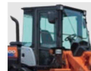
万一の事故からオペレータを保護するため、キャブには、ISO規格に適合したROPS\*とFOPS\*\*の保護構造を採用しています。
