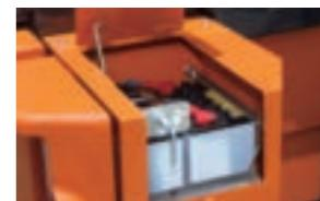
レバーを動かすだけで、簡単かつ安全にバッテリを遮断。メンテナンス中の感電事故を防止するとともに、長期不使用時に遮断することでバッテリの消耗を低減します。
