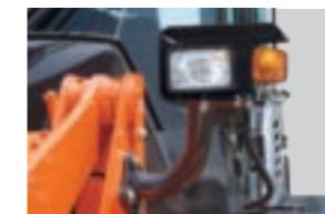
前照灯ブラケットのマウントに、防振ゴムを採用。ハロゲンランプと合わせ、球切れのリスクを低減します。
