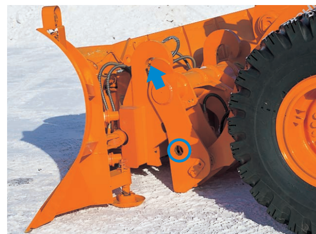
①リフトアーム先端をアタッチメント側に付いている取付けフックにかけます。
