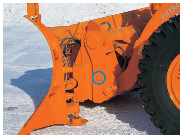
②取付けフックをかけたと同時に下側に付いているカブラピンを押込み装着完了です。
