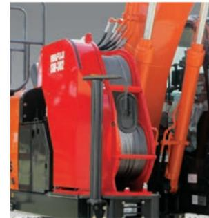
機械周辺の障害物からウインチを守るガードおよびロープの巻取り状態を確認するミラーを装備しています。
