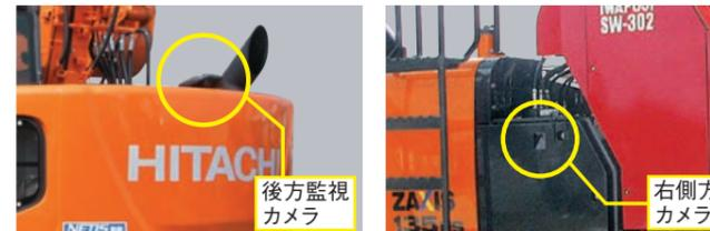
後方監視カメラに加え、右側方カメラを装備しました。右側方の視界を補助します。
