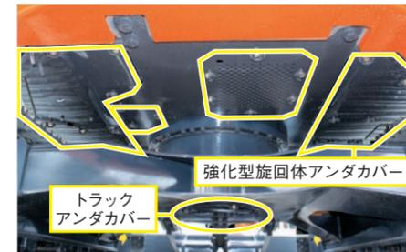
上部旋回体に強化型旋回体アンダカバーを、下部走行体にはトラックアンダカバーを装備しています。作業時に下からの突き上げによる油圧機器などの損傷を防止します。
