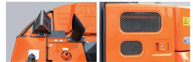
落ち葉や、土ほこりなどのエンジン室内への進入を防ぐため、吸い込み部分にメッシュカバーを装備しています。(エンジン室内への送風量確保のため、定期的な清掃が必要となります。)
