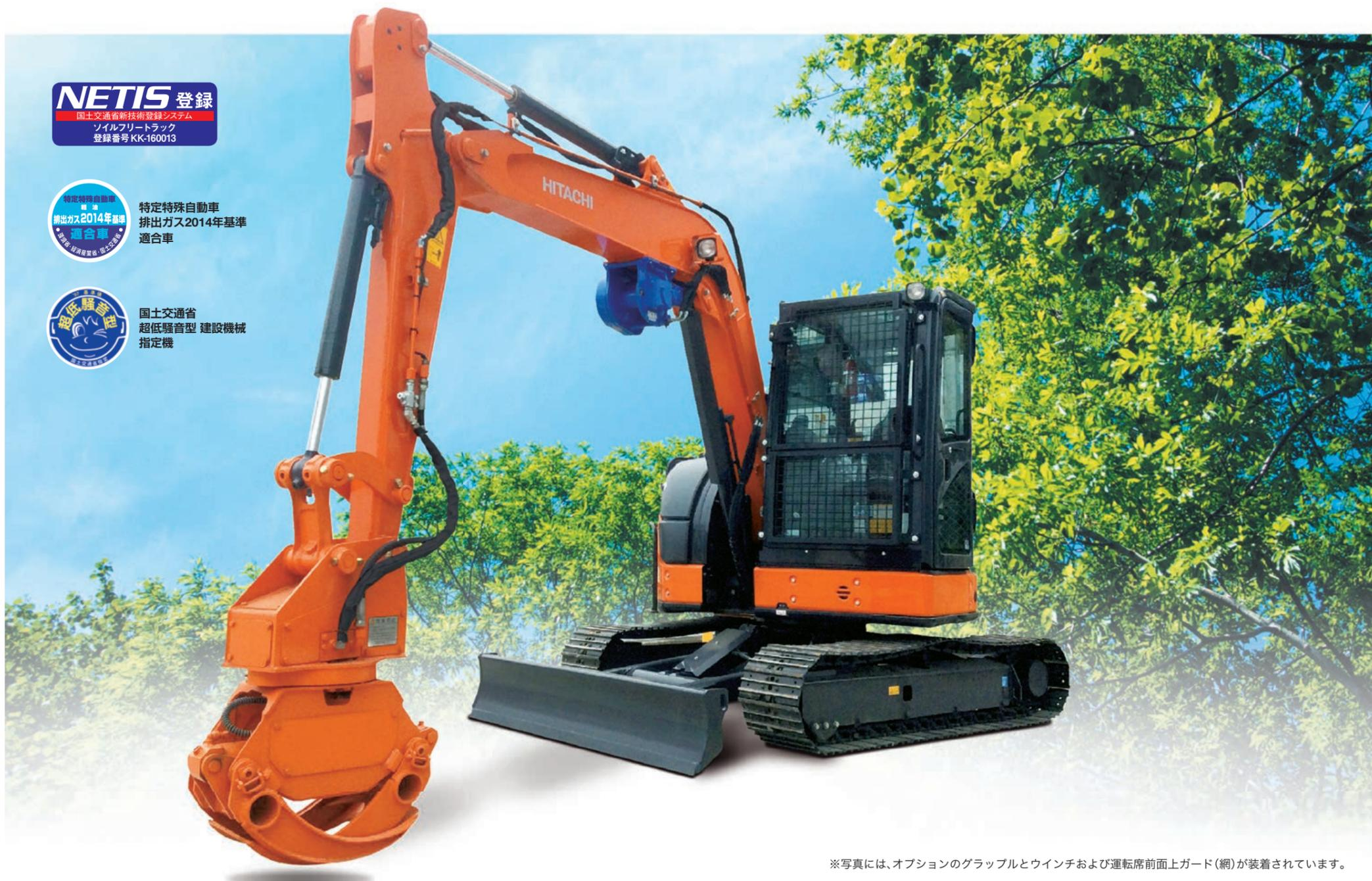
※写真には、オプションのグラブとウインチおよび運転席前面上ガード(網)が装着されています。
