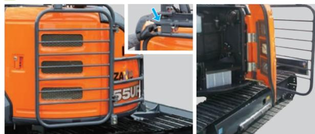
運転席から確認しづらい車体右側ボディを保護します。メンテナンス時は、バネ式のピンで扉が容易に開閉できます。
