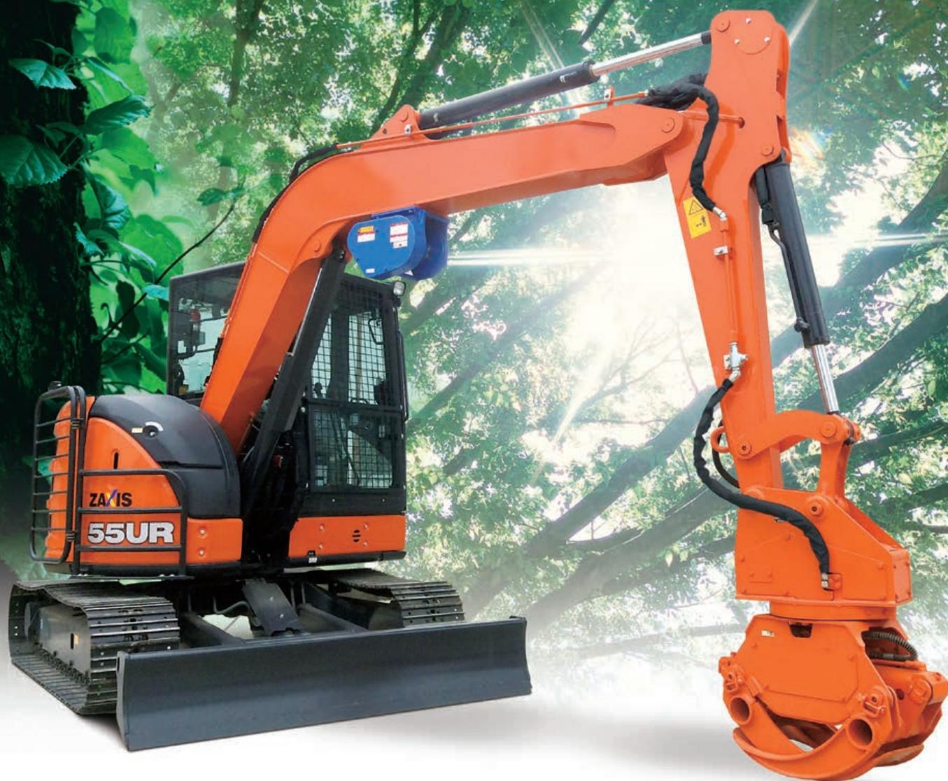
※写真には、オプションのグラップルとウインチおよび運転席前面上ガード(網)が装着されています。
