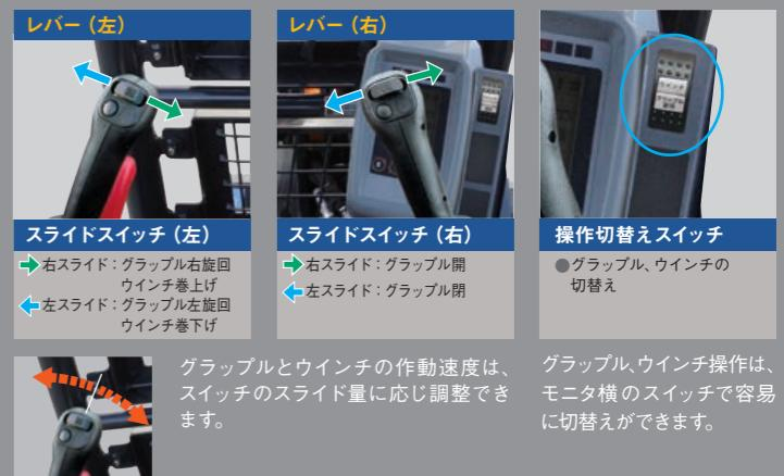
※電磁弁不付きグラップルとウインチを取り付けた場合の操作方式。
