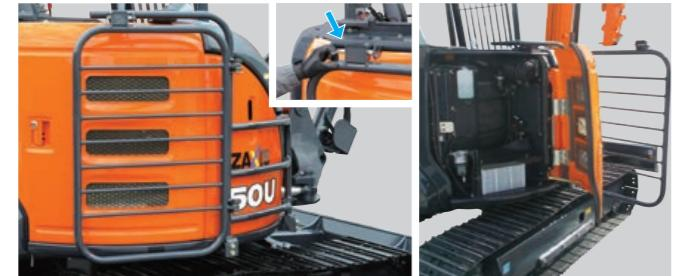
運転席から確認しやすい車体右側ボディを保護します。旋回体ガードはボルトで固定され、メンテナンス時の扉の開閉はバネ式のピンで容易に行えます。
