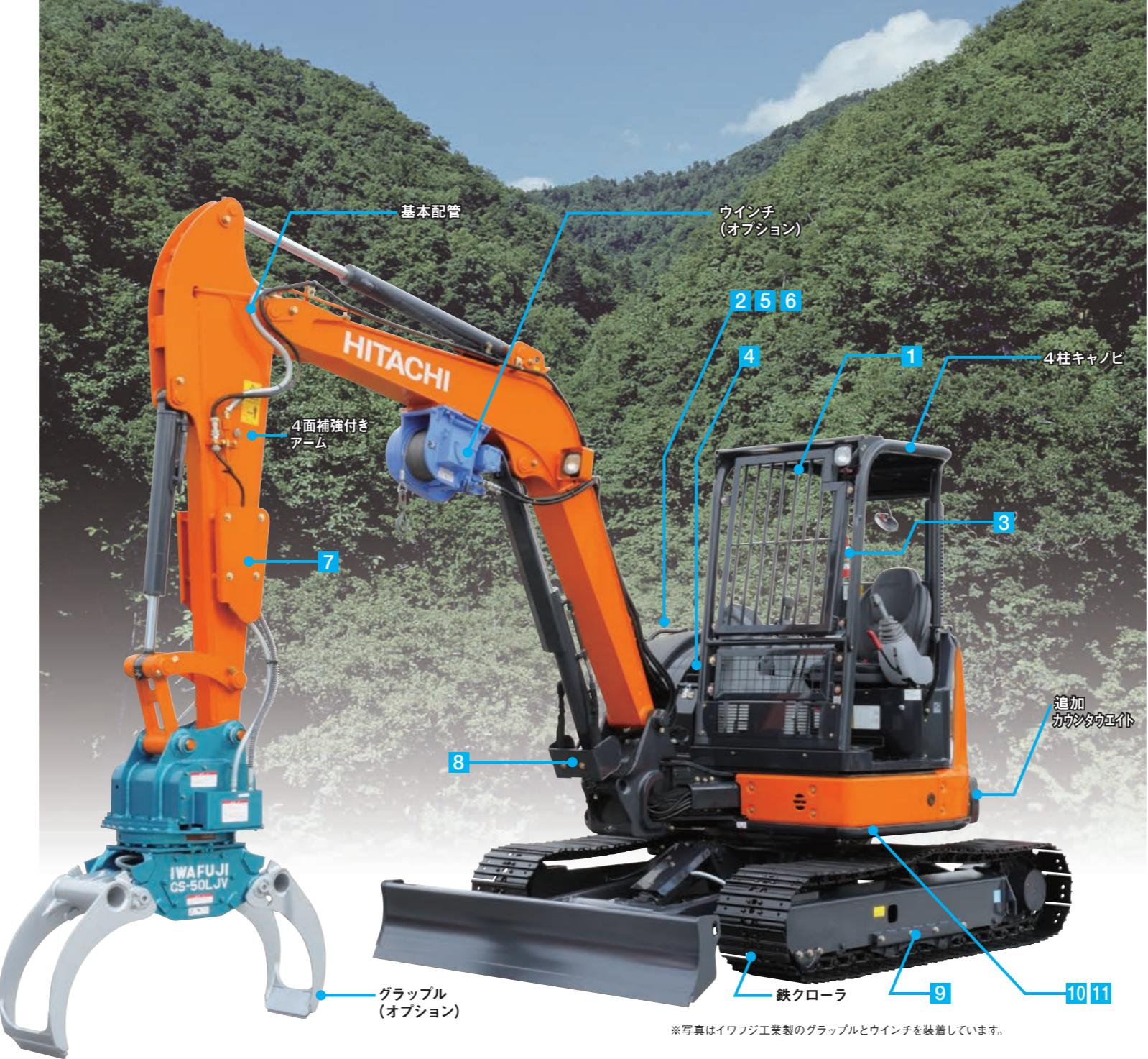
※写真はイワフジ工業製のグラップルとウインチを装着しています。
