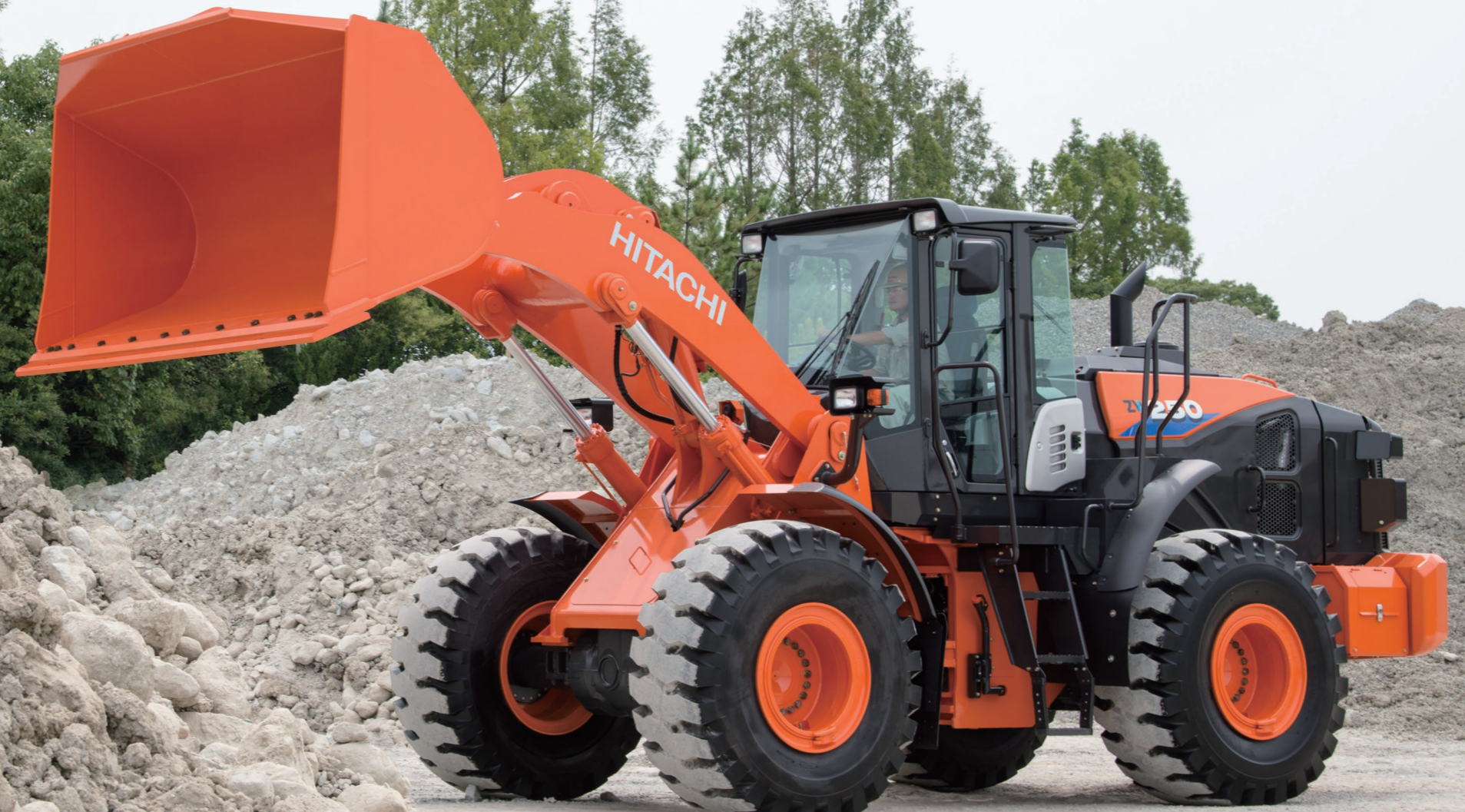
写真はオプションのバケットシリンダロッドガード、フェンダ（マッドフラップ付き）を装備しています。
