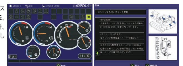
エンジン緊急停止スイッチ警報画面
