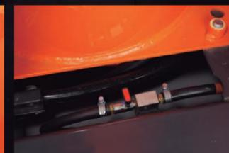
容易な燃料タンクの水抜き
