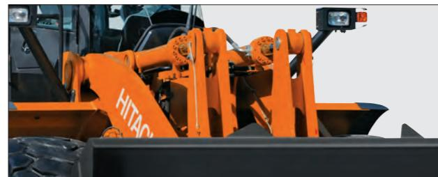
原石積みにおける偏荷重に対し、十分な耐久性を有するダブルZバーリンケージを採用しました。掘削・積込み時の荷重を効率的に分散させ、各ピニンの耐久性が向上、ねじれに対する剛性を高めました。
