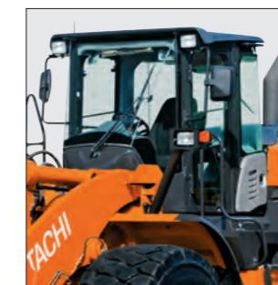
万が一の事故からオペレータを保護するため、キャブにはISO規格に適合したROPSとFOPSの保護構造を採用しています。
