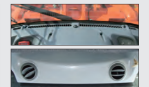
エアコン吹き出し口&デフロスタ
