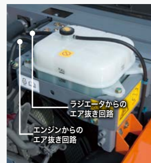
エキスパンションタンク
