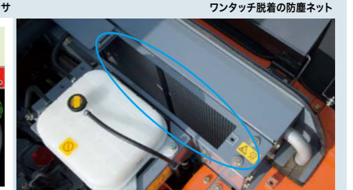
ワンタッチ開閉式のラジエータ清掃窓
