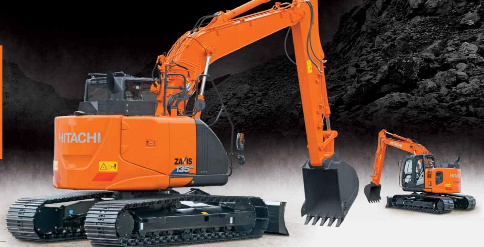
※写真は、オプションのアタッチメント基本配管、ブレーカー破砕機共用配管用 (NPK) およびブレードが含まれます。
