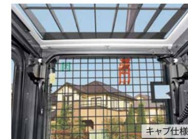
天井部に透明天窓を配置し、上方の視界を広くして作業効率を高めます。
