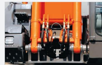
ブームシリンダ回路の破損などによるブームの落下を防止します。※移動式クレーンの安全機構を備えています。
