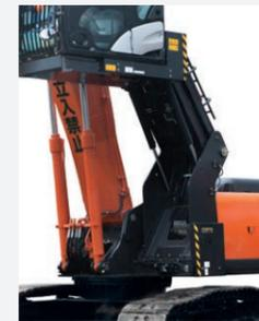
高いアイポイントにより、トラックへの積みみやプレス機、シュレッダへの投入状況の確認が容易です。BOX型リンクの採用および可動シリンダの取付位置変更により、剛性をアップ。さらに、フロント作動時のショックを抑える制御を実施し、キャブ揺れを大幅に低減しました。
