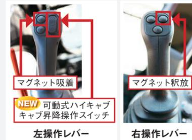
可動式ハイキャブの昇降操作をレバー部に設けるとともに、マグネットの吸着、釈放操作を左右操作レバーに分け、ボタン操作としました。また、マグネットの状態はモニターに表示されます。
