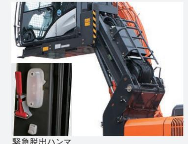
万一の場合、備付けの緊急脱出用ハンマでキャブ後ろ窓を割り、緊急脱出用はしごを使って、地上へ降りることができます。
