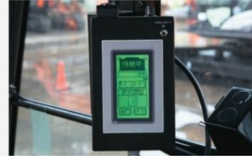
液晶モニターはタッチパネル式で画面を見ながら操作できます。作業目的に応じて、モニターで吸着・釈放の時間も容易に調整可能です。
