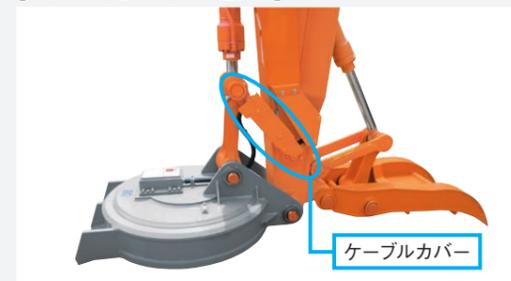
キャブタイヤケーブルをリンク部に配線し、さらにケーブルカバーを取り付けることで、つかみ物によるケーブル破損を防ぎます。
