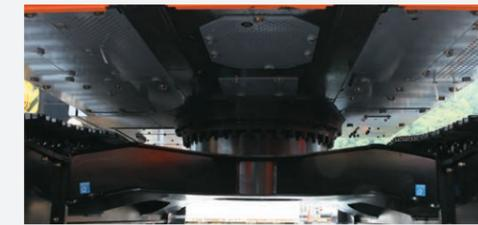
上部旋回体に強化型アンダカバーを、下部走行体にはトラックアンダカバーを採用しました。作業時の下からの突上げによる油圧機器などの損傷を防止します。
