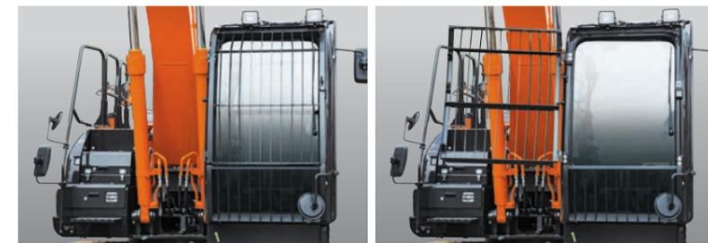
作業中、飛散物があった際にオペレータを保護します。上側ガードは、容易に開閉できるので窓の清掃が簡単です。
