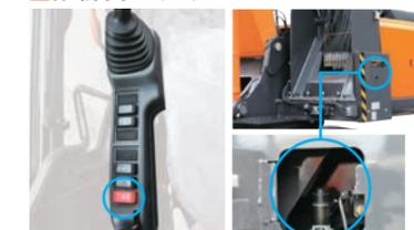
万が一、油圧系統や電気系統が故障した場合でも、リンクフォート部またはキャブ内の非常降下スイッチでキャブを下げることができます。
