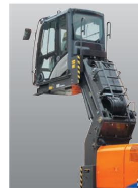
トラックへの積込みや、プレス機、シュレッダへの投入状況の確認が容易です。
