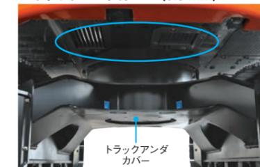
作業時に鉄筋などの突き上げからホース、配管、バルブなどを保護します。
