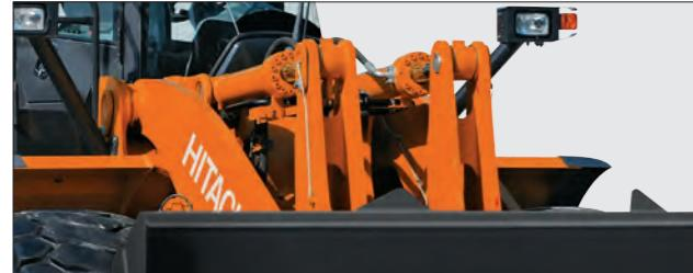
原石積みにおける偏荷重に対し、十分な耐久性を有するダブルZバーリンケージを採用しました。掘削・積込み時の荷重を効率的に分散させ、各ピニンの耐久性が向上、ねじれに対する剛性を高めました。
