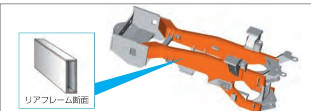
リアフレームにねじりに強いボックス断面構造を採用。さらに3D応力解析から得られた最適な構造にすることにより、高剛性化を実現しました。
