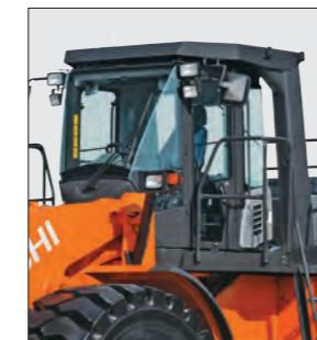
万が一の事故からオペレータを保護するため、キャブにはISO規格に適合したROPSとFOPSの保護構造を採用しています。
