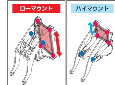
ピン間距離を十分に確保し、掘削時のリフトアームねじれを効率的に受けるローマウントリフトアームシリンダ方式を採用。さらにフロントアクスルの上に堆積した土砂や石によるリフトアームシリンダの破損を未然に防止します。
