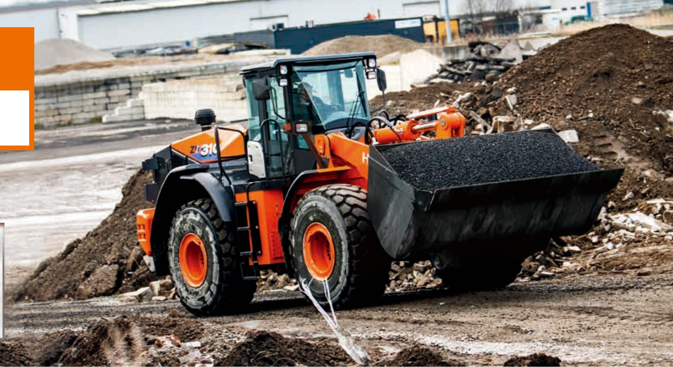
写真はオプションのラジアルタイヤ、フルフェンダ（マッドフラップ付き）、プレクリーナ（サイクロン式）、追加前方作業灯、バケットシリンダロッドガードを装備しています。
