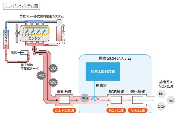
**尿素SCRシステム:**「尿素SCRシステム」はNOxを浄化する後処理技術です。エンジンの排出ガスは、連結パイプ内で噴射された尿素水（アンモニア）と混合し、SCR触媒およびDOC（ディーゼル酸化触媒）によって無害な水と窒素に分解。排出ガスのクリーン化に貢献します。
