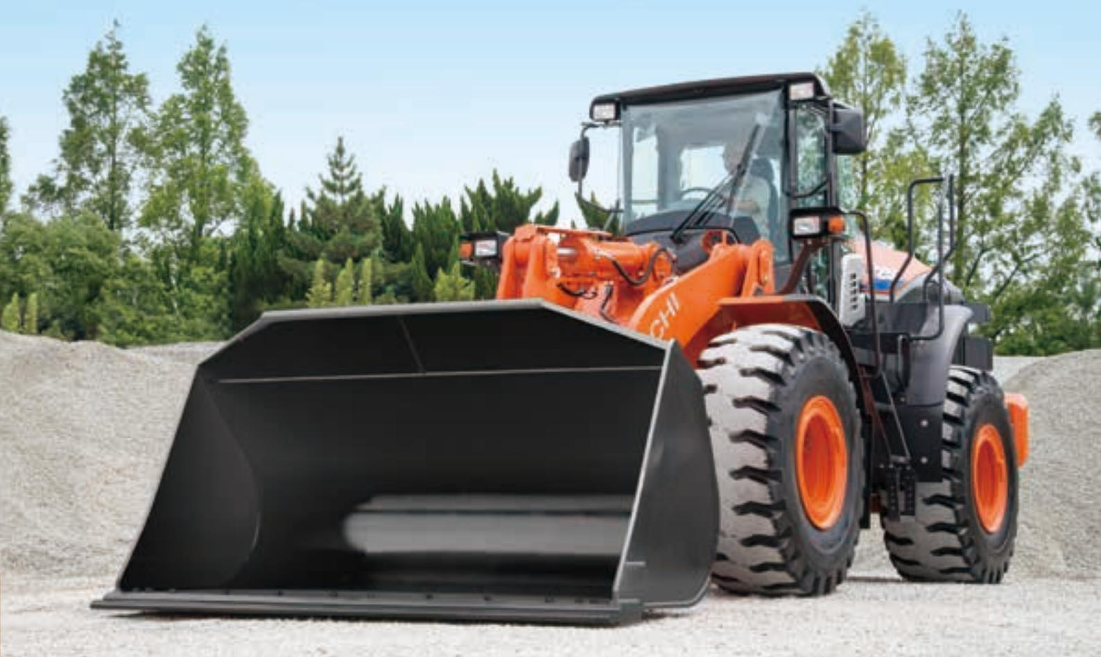
写真はオプションのバケットシリンダロッドガード、フェンダ（マッドフラップ付き）を装備しています。
