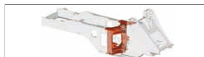
応力が集中するセンタヒンジ付近にボックス断面構造体を導入。3D応力解析から得られた最適な板厚によるメインフレーム構造、結合部に効果的な補強を加えるなど、車両の高剛性化を実現しました。
