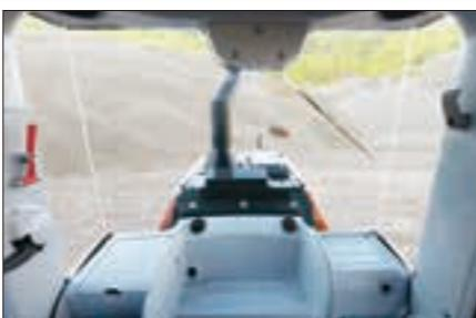
吸排気パイプの位置を変更することで、キャブ後方の視界が向上しました。狭い場所での後退時など、より安全に作業を行うことができます。
