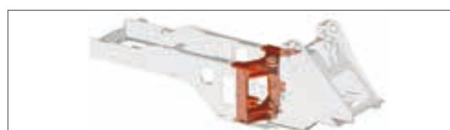
応力が集中するセンターハンジ付近にボックス断面構造体を導入。3D応力解析から得られた最適な板厚によるメインフレーム構造、結合部に効果的な補強を加えるなど、車両の高剛性化を実現しました。
