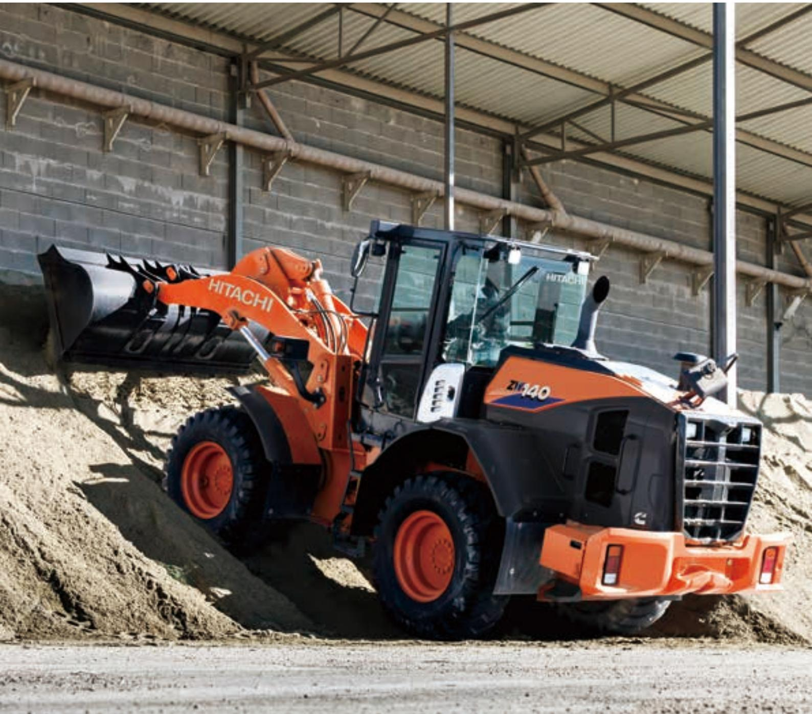
写真はオプションの追加前方作業灯(キャブ用、2灯)、後方作業灯(キャブ用、2灯)、フルフェンダ(マッドフラップ付き)、リアコンビネーションランプ(LED)を装備しています。
