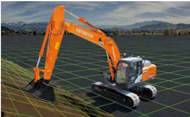
位置情報により掘削面を認識
