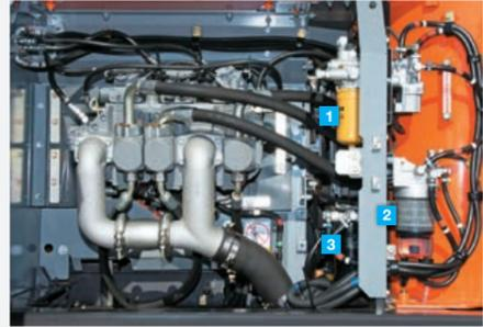
1 パイロットフィルタ 2 燃料プレフィルタ 3 燃料メインフィルタ
