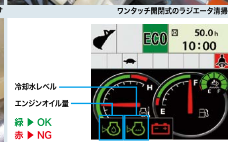
エンジンオイル量と冷却水レベルチェック画面
