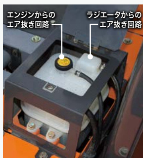
エキスパンションタンク
