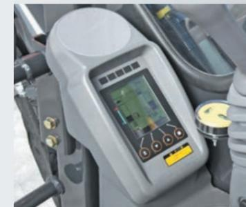
過負荷警報装置を内蔵。実荷重、定格荷重(定置)、高さ、作業半径を同時に表示できます。
