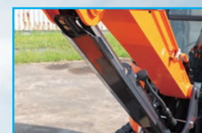
ブームシリンダカバー 山形保護プレートにより、ブームシリンダロッドを保護します。
