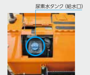
尿素水タンク (給水口)
