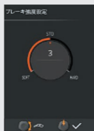
ブレーキ強度 モニタで5段階の調整が可能
