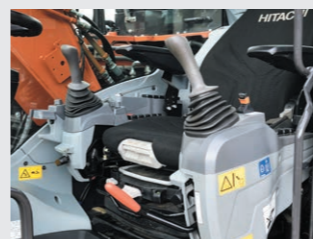
工具不要でコンソール高さを調整シートとコンソールの振動が同期 NEW
